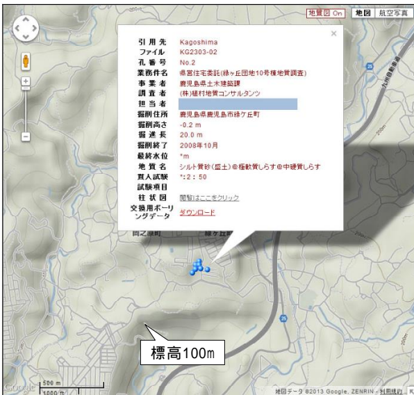
第 8 図 孔口高さが「標高」ではない例
